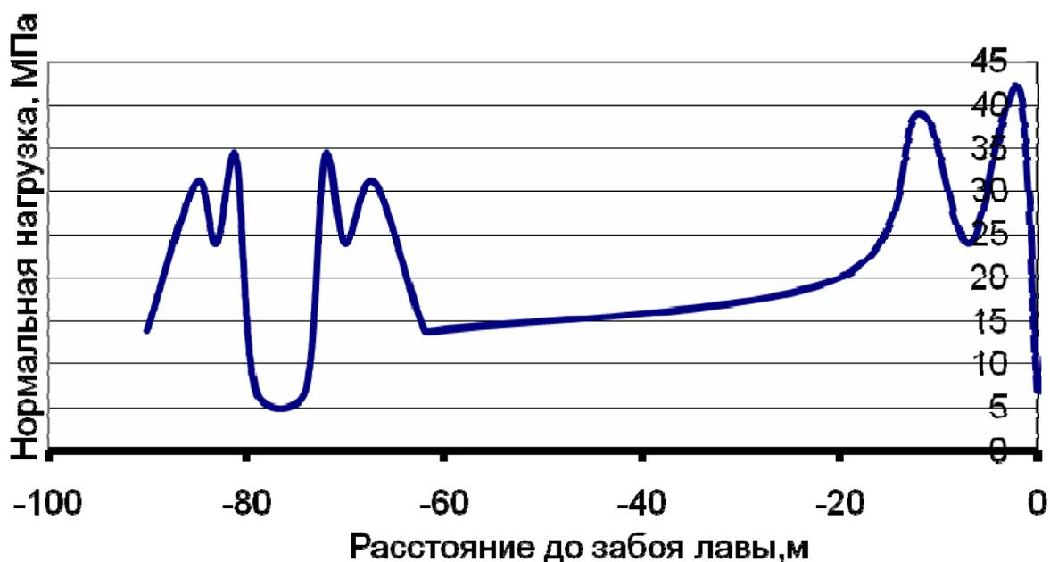
Рис. 3 - Распределение нормальных нагрузок в опорных зонах выработки и очистного забоя вне зоны влияния их друг на друга.
